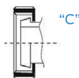
DIN M con girella DIN 11851 conical Coupling with nut
